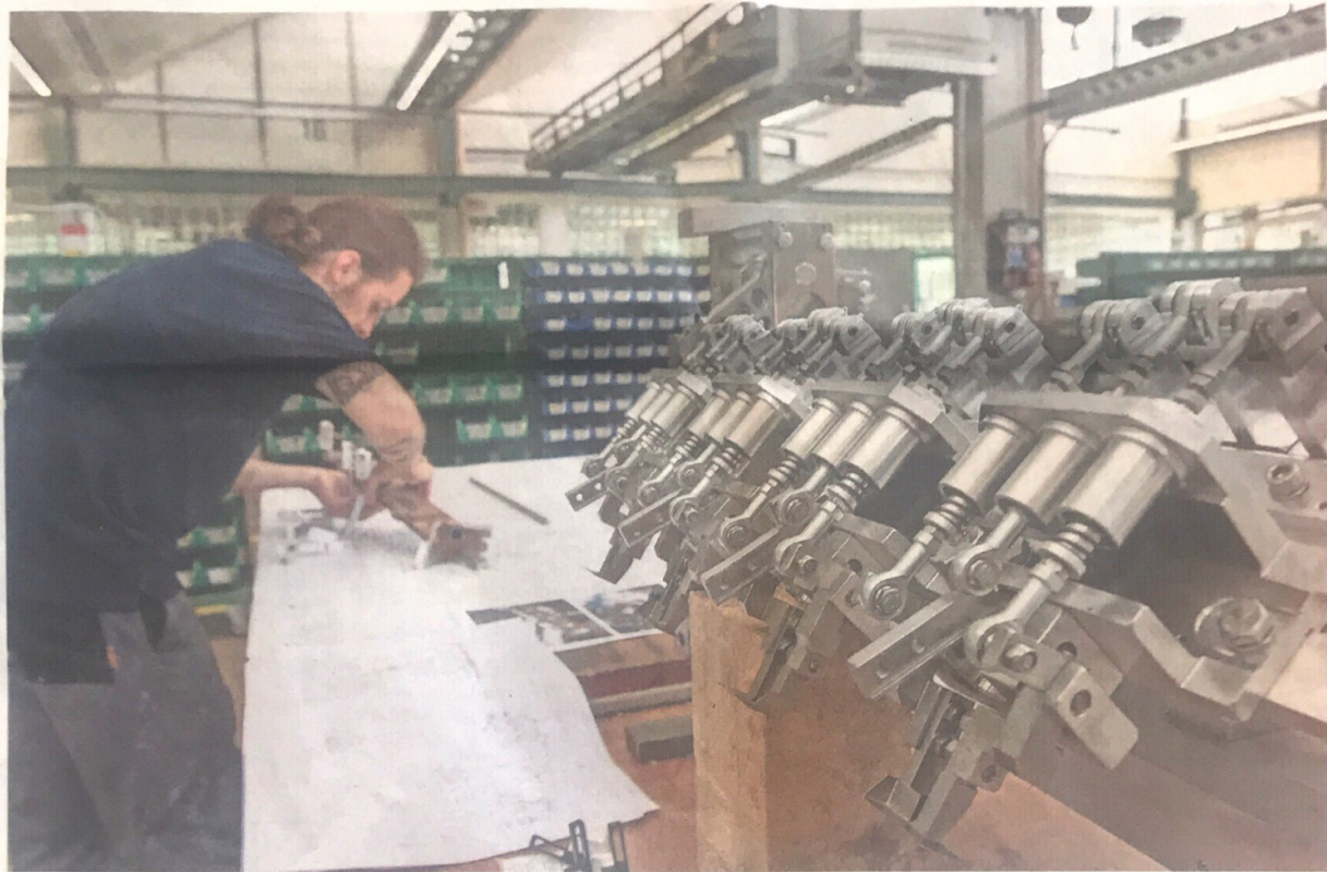
Montage du système mécanique de pliage pour une machine d'emballage de portions carrées de fromage fondu. VANESSA CARDOSO
